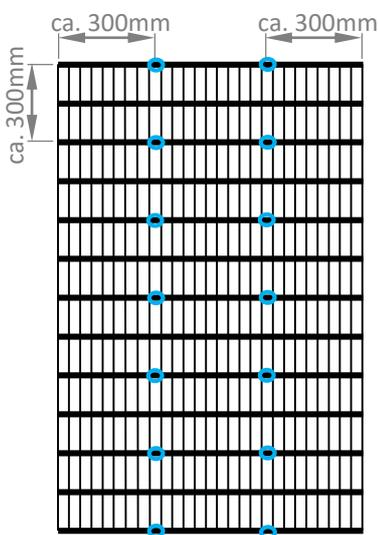
Verbinden Sie die Gitter gemäß dem gezeigten Abstandsschema mit Abstandhaken (14 Stück bei Gabione 90 x 180cm).
