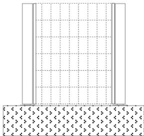
Das Anschlussprofil ist abgestimmt auf Sichtschutz-Elemente der max. Höhe  $H = 180\text{cm}$ .
