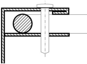
Setzen Sie das Gitter jeweils zwischen die Lasche und den Schenkel des Anschlussprofils.
